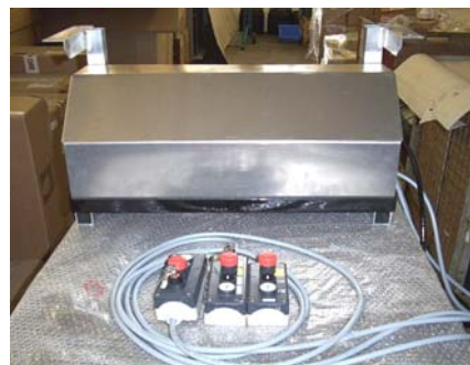
Hydraulikaggregat mit Lecköl-Wanne + Steuerung (separat montierbar) Bedienstationen verkabelt
